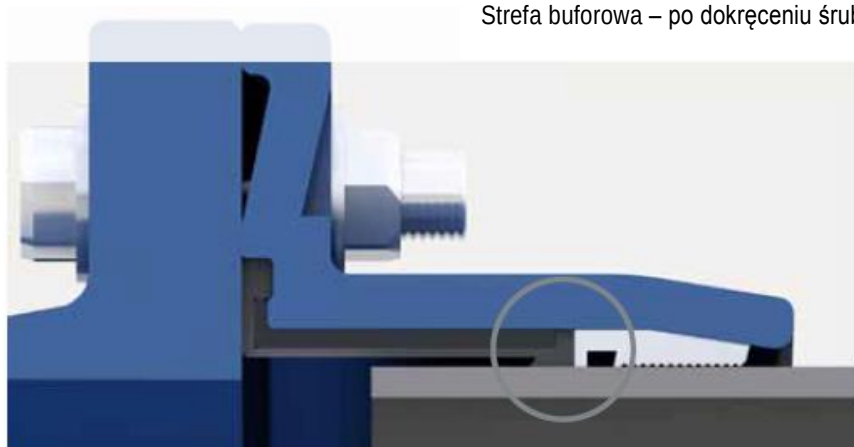
Strefa buforowa – po dokręceniu śrub
