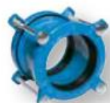
Seria 601 Łącznik kielichowy Supa® Do rur uPVC, AC, stalowych, żeliwnych Żeliwo sferoidalne DN 40-400 PN 16
