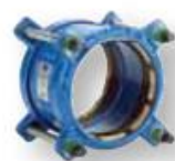
Seria 621 Łącznik kielichowy Supa Plus™ Do rur PE i uPVC Żeliwo sferoidalne DN 32-300 PN 16
