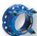
Seria 623 Łącznik kielichowo- kołnierzowy Supa Plus™ Do rur PE i uPVC Uniwersalne owiercenie Żeliwo sferoidalne DN 40-300 PN 10/16
