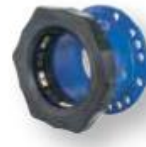
Seria 633 Łącznik kielichowo- kołnierzowy Supa Maxi™ Do wszystkich rodzajów rur Uniwersalne owiercenie Żeliwo sferoidalne DN 40-300 PN 10/16
