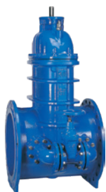
Typ 55 Zasuwa kołnierzowa DN 450-600 PN 10/16 GJS-500-7 Miękkie uszczelnienie Wymienne uszczelnienie trzpienia
