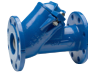
Typ 53 Zawór zwrotny kulowy DN 50-600 PN 10 GJS-400-15 DN 32-50 gwintowany
