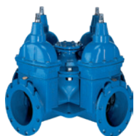
Typ 18 Krzyżak kołnierzowy z 4 zasuwami DN 100-300 PN 10/16 GJS-500-7
