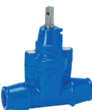
Typ 03/30 Zasuwa kielichowa przyłącza DN 20-50 PN 16 GJS-400-15 Pierścień wzmacniający do rur PE
