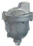
Typ S-012 • Zawór powietrzny do wody, wysokociśnieniowy • Gwint BSP 3/4", 1" • PN 40/63 • Staliwo P240GH • Automatyczny • 1-stopniowy
