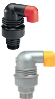
Typ D-040 Zawór powietrzny do wody DN 20-50 Gwint BSP 3/4", 1", 2" PN 10/16 Wzmocniony nylon Automatyczny - kinetyczny 2-stopniowy
