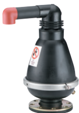
Typ D-025 Zawór powietrzny do ścieków DN 50-100 Gwint BSP 2", 3" PN 10 Wzmocniony nylon Automatyczny - kinetyczny 2-stopniowy
