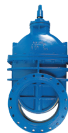
Typ 54 Zasuwa kołnierzowa DN 700-1200 PN 10/16 GJS-500-7 Uszczelnienie metal-metal Wymienne uszczelnienie trzpienia
