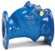
Typ 41 Zawór zwrotny klapowy DN 50-300 PN 10/16 GJS-500-7 Dysk wulkanizowany
