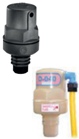
Typ S-050 Zawór odpowietrzający do wody DN 25 Gwint BSP 1" PN 16 Wzmocniony nylon Automatyczny 1-stopniowy
