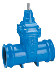
Typ 01/80 Zasuwa kielichowa do rur PVC DN 40-400 PN 16 GJS-500-7 Przyłącze typu "Euro"
