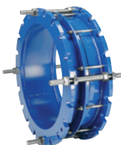
Typ 265 Łącznik montażowy kołnierzowy DN 50-1200 PN 10/16 DN 50-250 - GJS-400-10 DN 300-1200 - stal 1.0037
