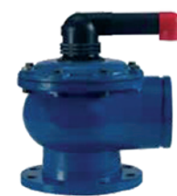
Typ D-070 • Zawór powietrzny do wody, przeciwuderzeniowy przeponowy • DN 80-250 • PN 10/16 • GJS-400-15 • Automatyczny-kinetyczny • 2-stopniowy
