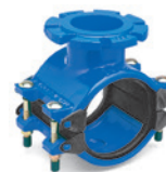
Typ 257 Obejma naprawcza z kołnierzem DN 100-300 Gaz: PN 7 Woda: PN 16 GJS-400-15
