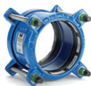
Typ 621 Łącznik kielichowy do rur PE i u-PVC, Supa Plus™ DN 32-300 GJS-400-15
