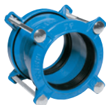
Typ 601 Łącznik kielichowy Supa DN 40-400 Gaz: PN 7 Woda: PN 16 GJS-400-15
