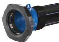
Typ 635 Łącznik kielichowy z króćcem PE, Supa Maxi™ DN 50-300 Gaz: PN 4/10 Woda: PN 10/16
