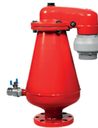
Typ D-023NS Zawór powietrzny do ścieków DN 80-200 Gwint BSP 3" PN 16 Stal 1.0037 Automatyczny - kinetyczny 3-stopniowy przeciwuderzeniowy
