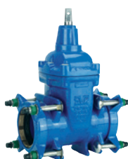
Typ 01/70 Zasuwa kielichowa do rur PE/uPVC DN 40-300 PN 16 GJS-400-15
