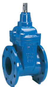
Typ 06 Zasuwa kołnierzowa DN 40-400 PN 10/16 GJS-500-7
